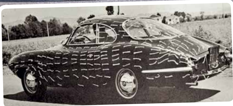
BILEN BLEV TESTET med papirstrimler under kørsel, så man kunne se, om vinden gled fint hen over bilen
