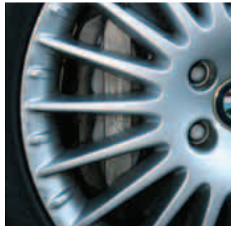
Forbremsene på 2.4 20V JTD og 3.2 Q4 er med fire stempler. Skiverne er 330 mm, og bagskiverne er ventilerede. På 2.2 og 1.9-modellerne er der enkelt-stemplede calipre og 305 mm skiver foran, og ikke ventilerede skiver bagpå.
