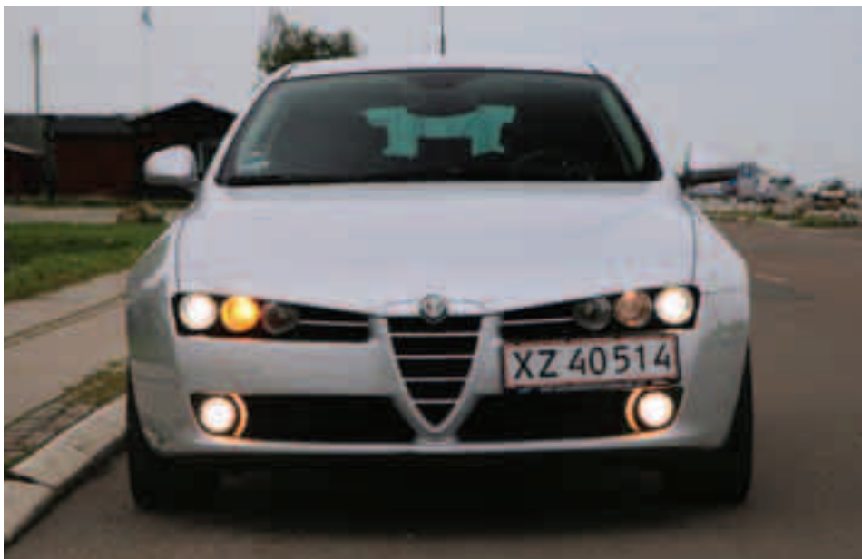
Seks forlygter og dertil tåglygter. De midterste af de tre forlygter i hver side er dels positionslys og dels blinklys. Det ses tydeligt på billedet.
