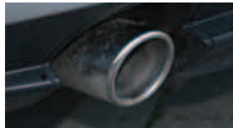
Selv efter mere end 10.000 km på bagen var udstødningsrørene næsten sodfrie, hvilket skyldes partikelfilter. Det er rigtig godt for miljøet.
